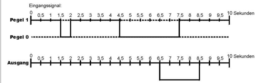
In diesem Fall wurde eine Haltezeit von 2 Sekunden eingegeben. Der digitale Eingang ist im Ruhezustand von der Masse getrennt und bei Ereigniseintritt wird dieser Kontakt geschlossen. In dieser Konstellation wirkt sich die Haltezeit so aus, dass nur Eingangssignale, welche 2 Sekunden und länger anliegen, auch registriert werden. Kürzer anliegende Signale werden ignoriert. Somit lassen sich auch unerwünschte Preller bei Relais ausfiltern oder flattern an den Eingängen.
