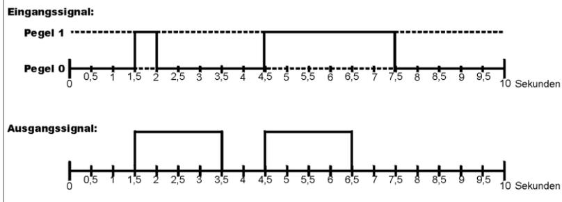
Auch in diesem Fall wurde eine Haltezeit von 2 Sekunden eingegeben. Der digitale Eingang ist im Ruhezustand mit der Masse verbunden und wird bei Ereigniseintritt von dieser getrennt. In dieser Konstellation wirkt sich die Haltezeit so aus, dass jedes Eingangssignal, egal von welcher Länge, dem Gerät 2 Sekunden zur Verfügung stehen. Somit werden auch kleine Wischer registriert und auf die Zeit verlängert, welche der Prozessor zum Abarbeiten benötigt.
