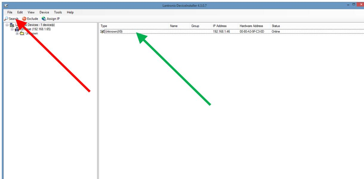
„Doppelklick“ auf das gefundene Gerät, die Einstellmöglichkeiten öffnen sich. In den Einstellmöglichkeiten **Web Configuration** wählen
